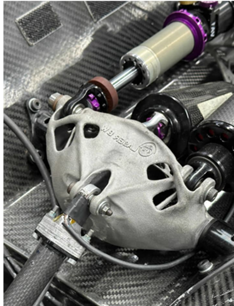
Rockerwellen von 3D Laser BW für den Rennwagen des Rennstalls der Hochschule Esslingen
