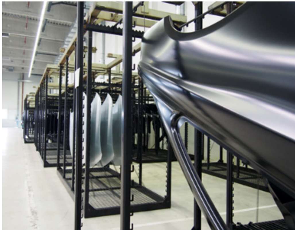
Die neue Vorbehandlungs- und KTL-Anlage im Werk Benseler in Bogen ermöglicht, Bauteile mit immer komplexer werdenden Geometrien und Werkstoffkombinationen zu beschichten. Quelle (zwei Fotos): Redaktion
