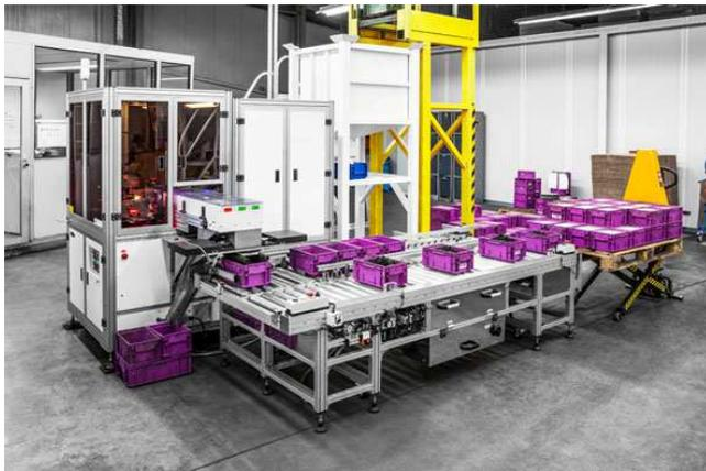
Die neue Sortiertechnik sortiert fehlerhafte Teile bis auf wenige ppm (parts per million) aus. Teile, die die Slot- und Glastelleranlagen als NiO (Nicht in Ordnung) erkennt, landen in einem separaten Behälter. Wenn sie auch ein zweites Mal der Sichtung nicht standhalten, werden sie als Schrott deklariert.
