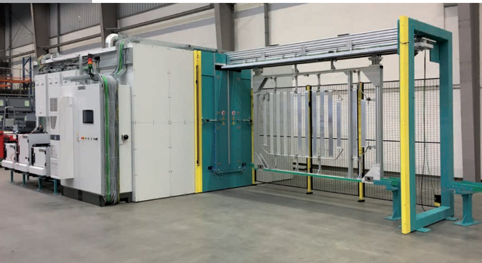
Die Laseranlage zur Vorreinigung von komplexen Geometrien ist eine Eigenentwicklung der BENSELER-Gruppe.
