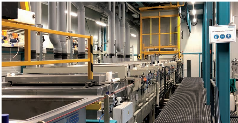
Exakt aufeinander abgestimmt: Beim CBE-Verfahren durchlaufen die Komponenten je nach Anforderung 14 bis 16 Stationen.
